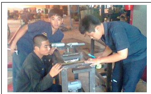
ภาพที่ 22 ทดลองประกอบเครื่องอัดถ่านแท่งภาพที่
