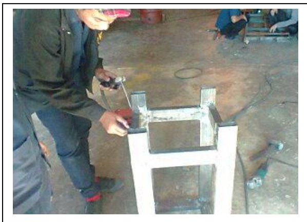
ภาพที่ 18 ชั้น โครงเครื่องบดผสม
