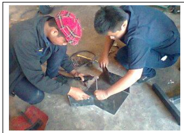
ภาพที่ 19 ประกอบกรวยใส่ถ่านผง ของเครื่องบดผสม
