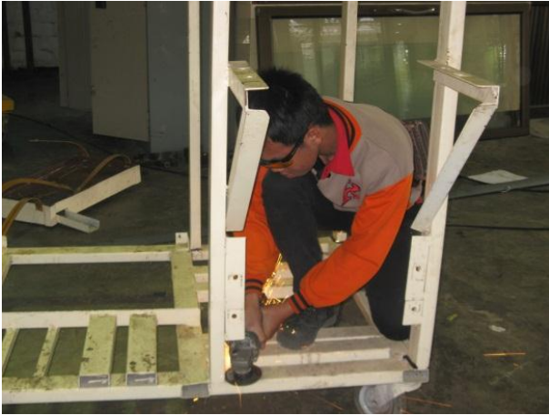
รูปที่ 2 ตัดโครงเครื่องเดิม
